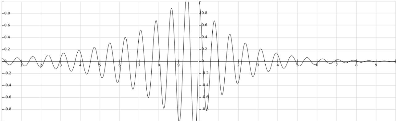
$s(t)$  pour un système instable (gauche) et pour un système stable (droite)
