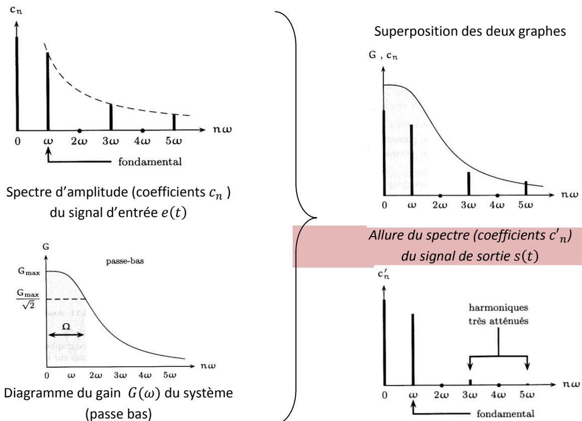
Sur cet exemple, seules subsistent de façon notable la composante continue et le fondamental :
