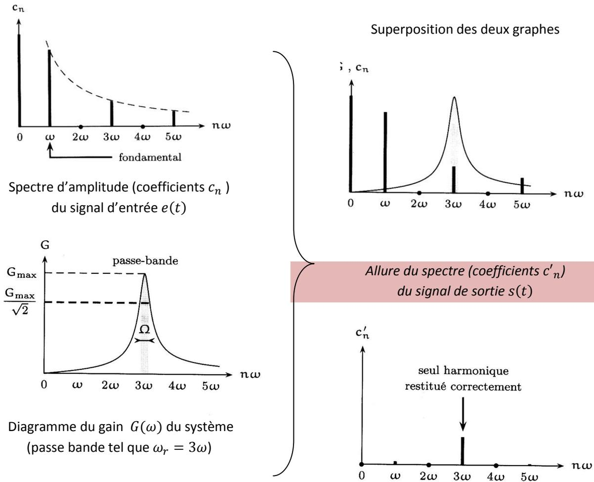
Comme le filtre est très sélectif, facteur de qualité  $Q$  très élevé, le signal de sortie est sinusoïdal sans composante continue. Si  $Q$  était moins élevé, il pourrait subsister d'autres raies dans le spectre du signal de sortie et celui-ci ne serait plus sinusoïdal.
