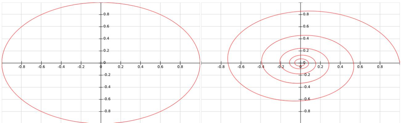
Portraits de phase pour un système en limite de stabilité (gauche) et stable (droite), conditions initiales (1,0)
